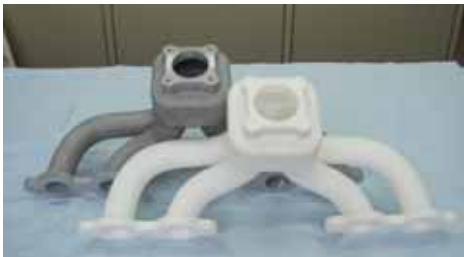
自動車部品インテークマニホールド 鋳造用マスターRPモデル（白） とアルミ鋳造品
